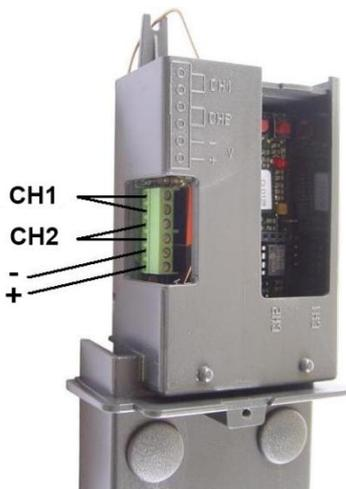
1. Togliete la corrente all'istallazione. Verificate che l'alimentazione sia a 12V o 24V, su corrente alternata o continua. Collegate l'alimentazione tra i terminali « - » et « + » (se la corrente é alternata non sarà necessario rispettarne il senso). Se la tensione dell'alimentazione é più elevata, dovrete installare il trasformatore adatto alla corrente della ricevente.
